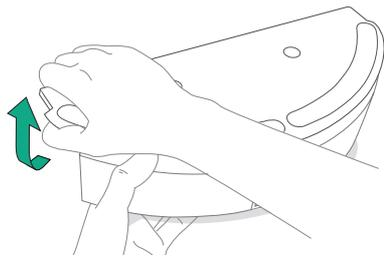
**3** Zláhka navlhčíte mopovaciu podložku a pripevníte ju na platňu na podložku.
