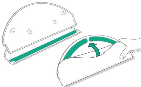
**4** Remontați placa pentru pad pe coșul colector.
