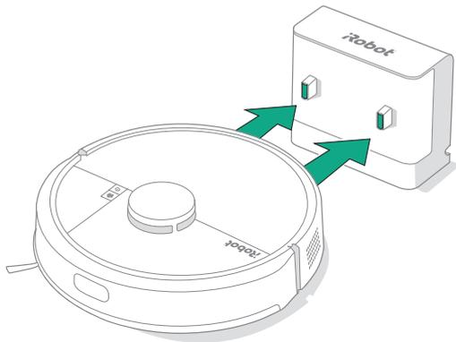
Umiestnite robota pred stanicu, potom ho posuňte smerom k stanici a zarovnajete kovové nabíjacie kontakty. Po niekoľkých minútach vám zvuk bude signalizovať, že je zapnutý.
