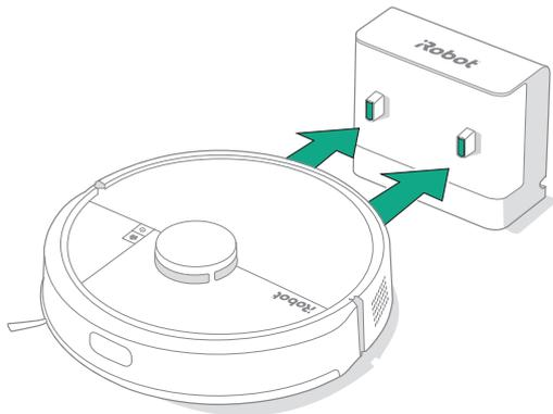
Poziționați robotul în fața stației de încărcare și deplasați-l către aceasta, astfel încât contactele metalice de încărcare ale stației de bază să intre în contact cu cele ale robotului. După câteva minute, veți auzi un semnal sonor care indică faptul că robotul a început să funcționeze.
