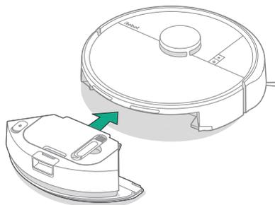
**7** Robot umiestnite späť do stanice a pomocou tlačidiel aplikácie alebo robota spustíte upratovanie.
