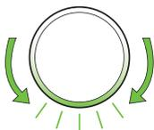
Atunci când robotul detectează că trebuie golit coșul colector, inelul luminos se va aprinde roșu semnalizând partea din spate.
