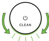
Atunci când robotul detectează că trebuie golit coșul colector, inelul luminos se va aprinde cu roșu cu o mișcare de curățare către partea din spate.
