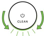
Amikor a robot érzékel, hogy a portartály ki kell üríteni, a fénygyűrű kijelző pirosan világít a hátsó rész felé irányuló törlő mozdulatokkal.
